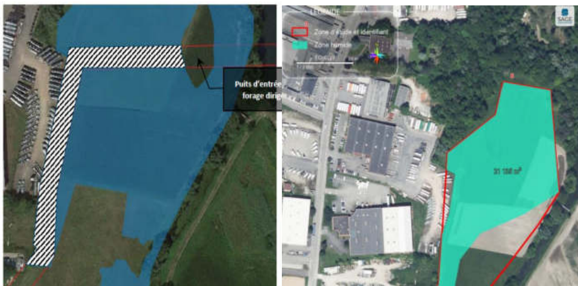
Figure 11 – Emprise de la zone humide pédologique concernée par l'aménagement des tranchées pour la pose des canalisations de transfert au nord de la station de prétraitement de Fegersheim (à gauche) et cartographie du rapport SAGE Environnement de janvier 2023 (à droite)
