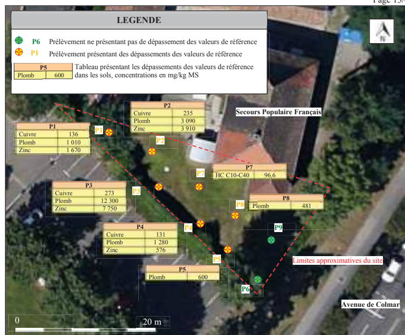
Figure 2 : Plan de dépassements des valeurs de référence dans les sols (octobre 2016 – extrait du rapport EnvirEauSol SSP_360/EMS024)
